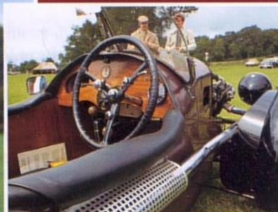
Cockpit eines Super-Sports: Gashebel und Zündverstellung am Lenkrad, „Rex-Gummi“ als Rückholfeder.
